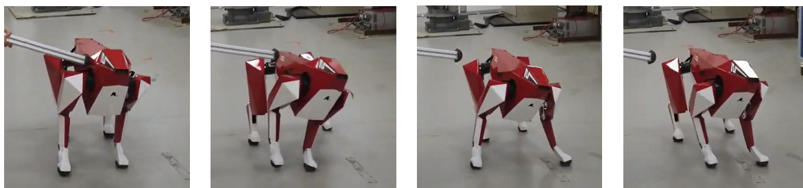
Obr. 4.22: Priebeh postrčenia do robota.
