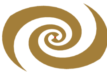
Obr. 17 Plošná špirálová anténa
