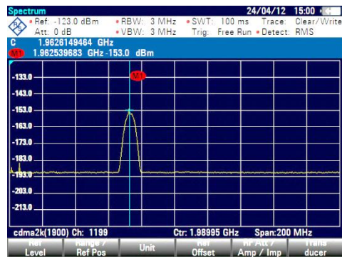
Obr. 53 Uložená obrazovka merania kanála 1900 MHz
