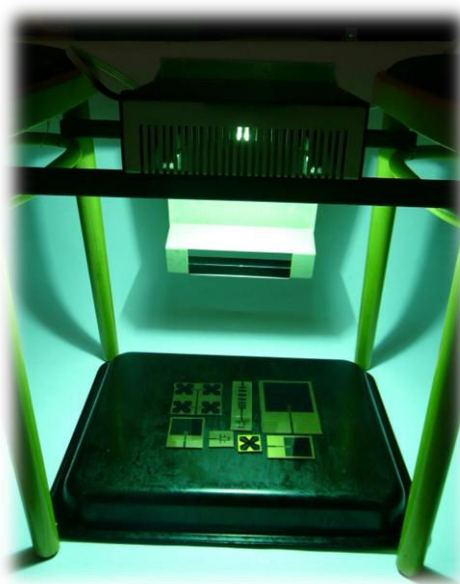
Obr. 45 Osvit DPS horským slnkom (UV žiarením)
