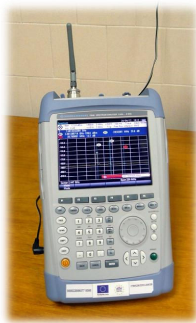
Obr. 49 Meranie frekvenčného spektra spektrálnym analyzátorom R&H FSH8
